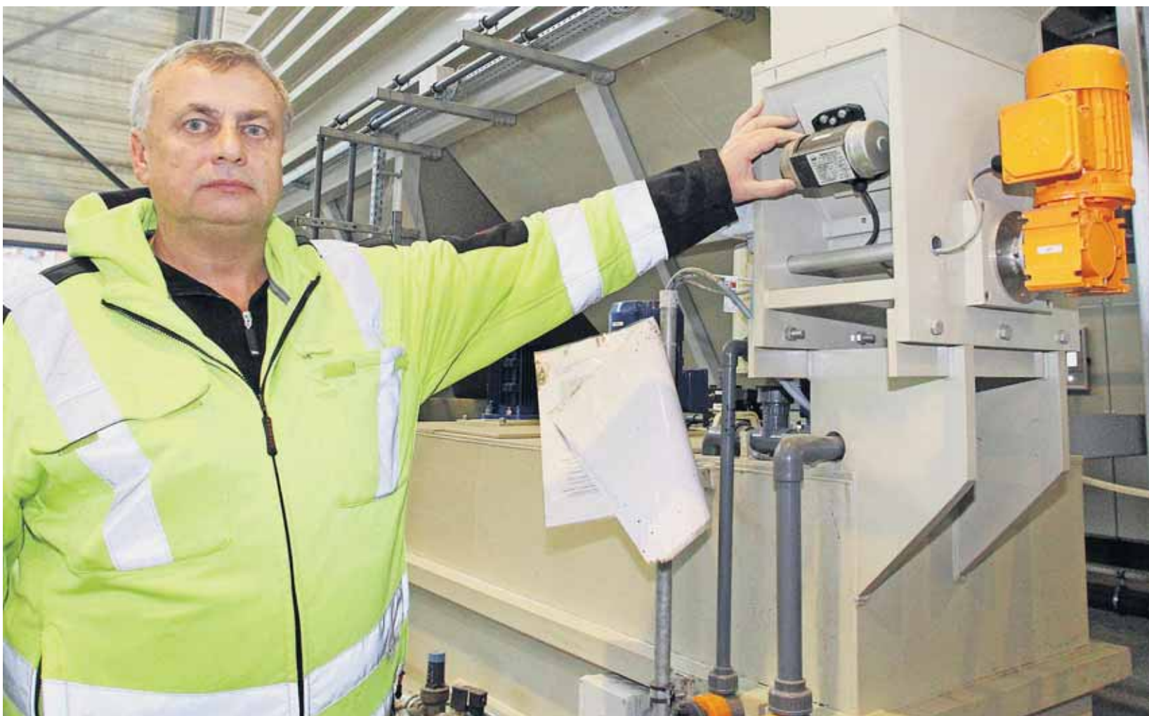
Willi Streit, der Geschäftsführer der Eu-Rec GmbH, zeigt auf eine neue Reinigungsanlage. Sie soll dafür sorgen, dass die Wasserdämpfe, die in der Firma bei der Aufbereitung von Kunststofffolien zu Agglomerat entstehen, nicht mehr so stark riechen. TV-FOTO: ARCHIV/FRIEDEMANN VETTER
